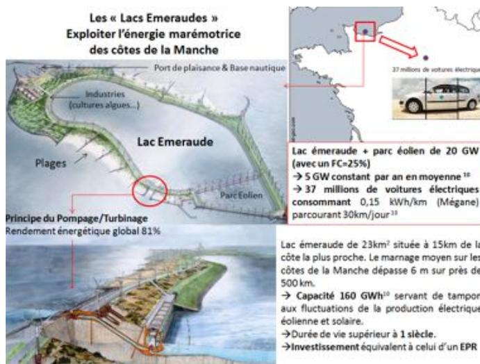
Figure 2 : Les Lacs Emeraudes, une solution ambivalente pour exploiter l'énergie marémotrice des côtes de la Manche
